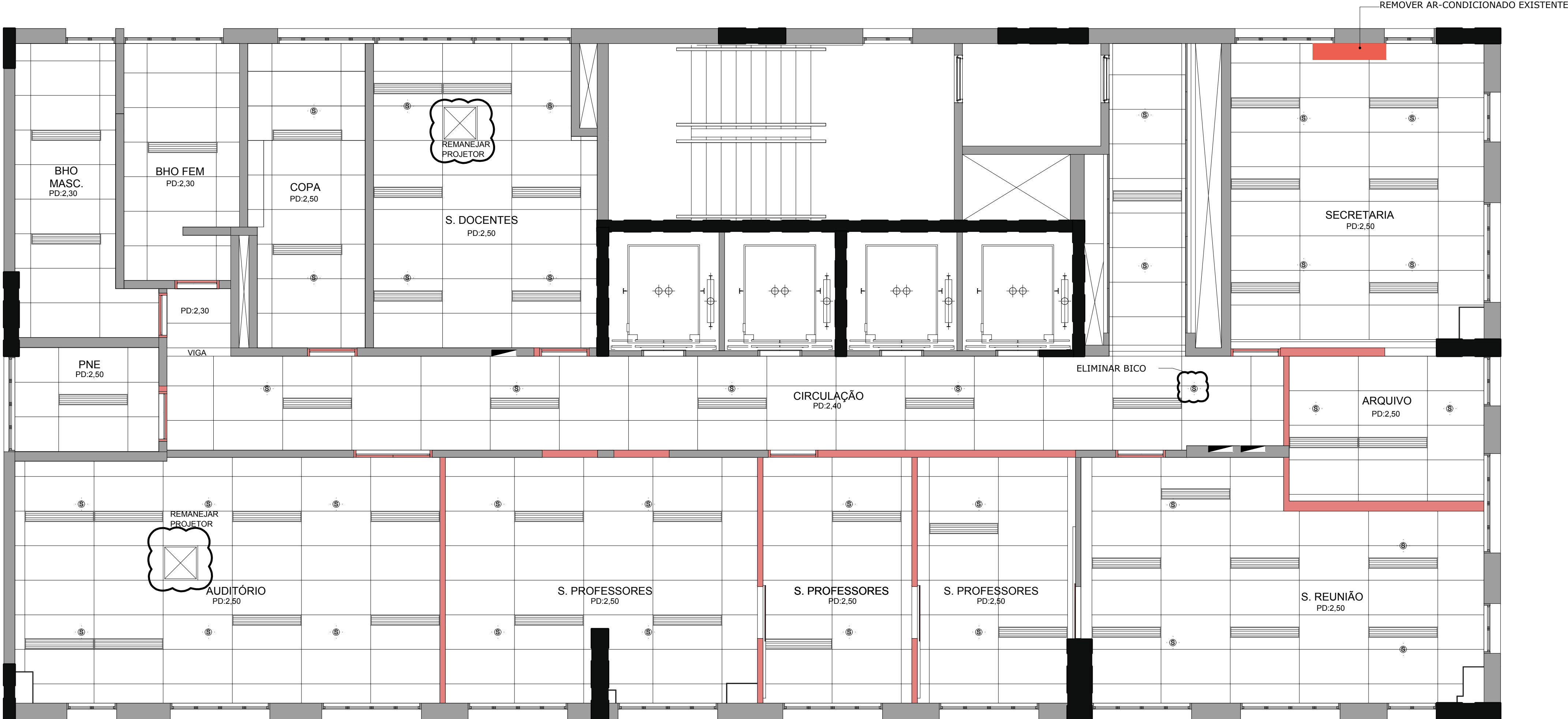
PLANTA DE FORRO - DEMOLIÇÃO ESC: 1/50
